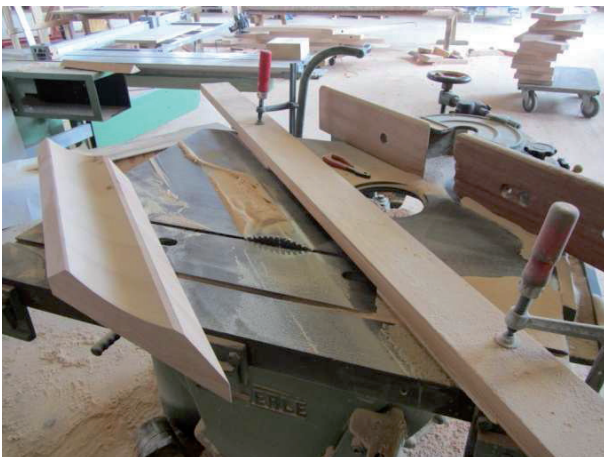
Ausarbeitung und Anpassen des Kropfstückes an die Lichtwangen
